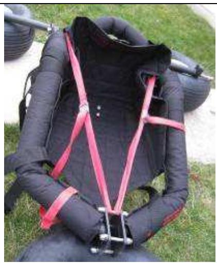
Desserrer les 4 vis du dossier. / *Unscrew the 4 back pipe screws.*
